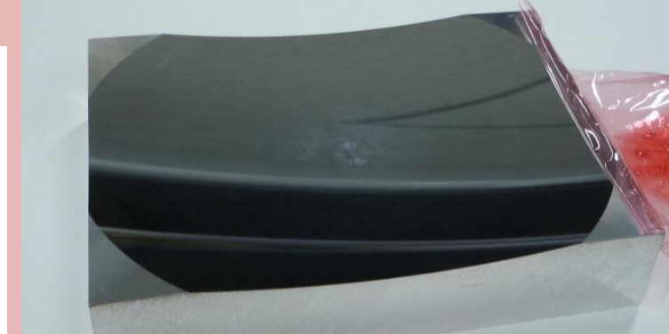
試作品の写真。中央に少し乱れが見えるが、この部分もRa<5nmである。
