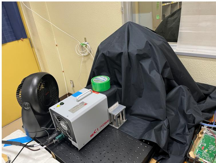
図 4.4: 黒体炉によるフラット画像取得のセットアップ。外部からの迷光の影響を軽減するために黒い遮光布を被せてある。
