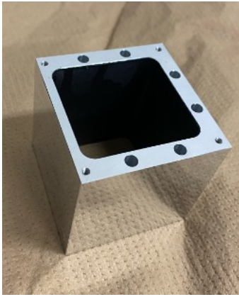
図 6.4 蓋柱の写真：壁面の反射を抑えるために、内壁をサンドブラスト後、黒塗、ベーキングした
