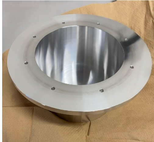
図 6.5 新フランジの写真：ハット型の構造で、蓋柱が当たらないように空洞がある
